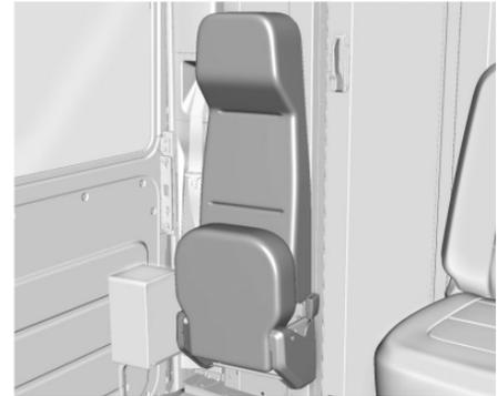
Pour utiliser le strapontin, tirer sur le coussin du siège jusqu'à ce que le siège soit en place. Pour ranger le siège, remettre le coussin du siège en position verticale.
