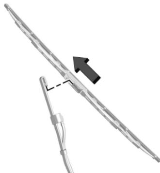
2. Tirer l'ensemble du balai d'essuie-glace vers le bas, vers le pare-brise, suffisamment pour le dégager de l'extrémité du bras d'essuie-glace munie d'un crochet en J.
