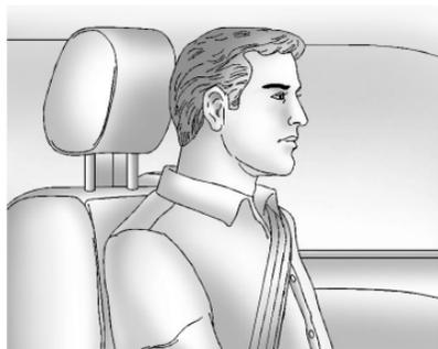
Régler l'appui-tête de sorte que sa partie supérieure arrive au niveau du haut de la tête de l'occupant. Cette position réduit les risques de blessure à la nuque lors d'un accident.
