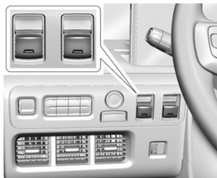
Les lève-glaces électriques fonctionnent lorsque le contact du véhicule est mis.
