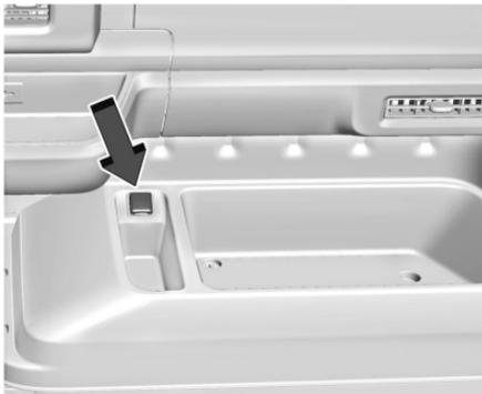
Le véhicule est équipé d'une prise de courant pour accessoires sur la colonne inférieure centrale sous la commande de climatisation.
