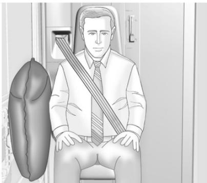
Si le véhicule en est équipé, le coussin gonflable de sécurité côté passager se trouve sur le couvercle de la garniture de coussin gonflable, à côté du strapontin.
