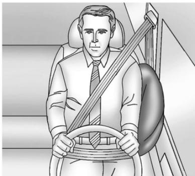
Le véhicule est équipé d'un coussin gonflable latéral monté sur le siège du conducteur, sur le côté du dossier le plus proche de la porte.
