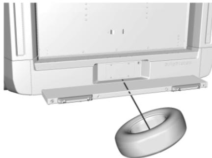
5. Pencher le pneu vers le véhicule avec un relâchement dans le câble afin d'accéder à la retenue de pneu/roue.
