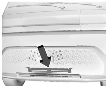
Le véhicule peut avoir un système de volet conçu pour améliorer l'efficacité énergétique. Garder le système d'obturation à l'écart des débris, de la neige et de la glace. Si le témoin de rappel d'entretien du véhicule est activé, vérifier si le système d'obturation est exempt de débris, de neige et de glace.
