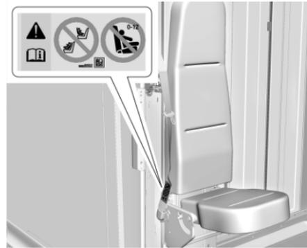
L'étiquette illustrée ci-dessous est située sur l'ancrage extérieur de la ceinture de sécurité du côté passager.
