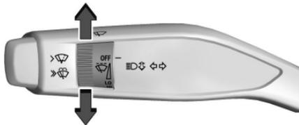
Le levier de l'essuie-glace/lave-glace se trouve sur le côté gauche de la colonne de direction. Le véhicule étant en marche ou en mode accessoire, déplacer le bouton d'essuie-glace du pare-brise pour sélectionner la vitesse de l'essuie-glace.
