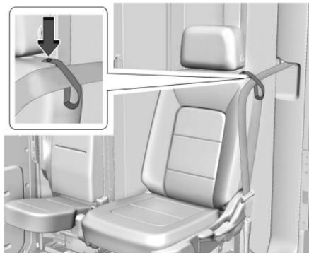
Si le siège possède un guide de ceinture de sécurité, la ceinture de sécurité doit être acheminée à travers le guide pour placer correctement la ceinture épaulière. Si la ceinture de sécurité n'est pas acheminée à travers le guide, faire glisser le bord de la sangle à travers l'ouverture du guide. La sangle ne peut être tordue.
