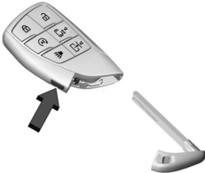
La clé mécanique de l'intérieur de la télécommande est utilisée pour la porte arrière.
