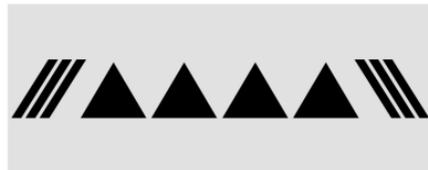
Lorsque le véhicule s'approche trop rapidement d'un piéton détecté, l'affichage rouge du système FPB clignote sur le pare-brise. Huit alertes sonores aiguës retentissent rapidement à partir de l'avant, ou les deux côtés du siège à alerte de sécurité vibrent à cinq reprises. Lorsque cette alerte de piéton se déclenche,
