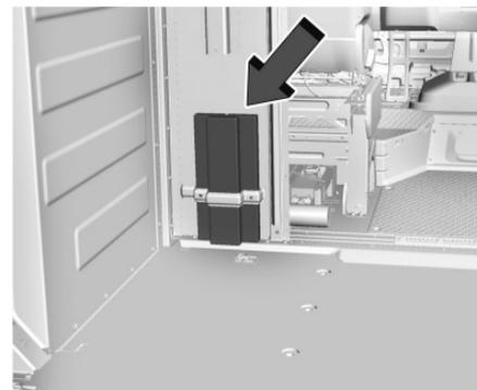
Si le véhicule en est équipé, les triangles d'avertissement sont situés derrière le siège du conducteur, dans une cloison. Pour les retirer, les soulever du support de rangement.
