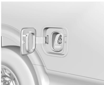
5. Brancher le cordon de charge CA dans le port de charge du véhicule. S'assurer que la fiche véhicule de courant alternatif est entièrement emboîtée dans le port de charge en courant alternatif. Si elle n'est pas correctement connectée, le véhicule risque de ne pas être chargé.
