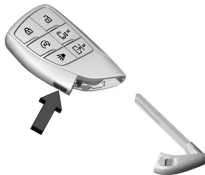
1. Appuyer sur le bouton sur le côté de la clé télécommande près de la base et extraire la clé mécanique. Ne jamais retirer la clé mécanique sans appuyer sur le bouton.
