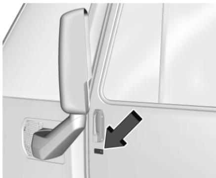
La clé télécommande doit se trouver à moins de 1 m (3 pi) de la porte (y compris la porte coulissante) à ouvrir ou à verrouiller. Appuyer sur le bouton situé près de la poignée de la
