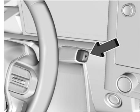
Cette position bloque les roues motrices. Engager la position P (stationnement) au démarrage du véhicule pour s'assurer que le véhicule ne bouge pas.
