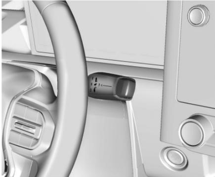
Le véhicule utilise une unité d'entraînement électrique. La grille de rapports de vitesses est affichée sur l'avant du levier de vitesses. La position du rapport sélectionné s'éclaire en rouge sur le levier de vitesses, tandis que les autres rapports restent éclairés en blanc. Si le changement de rapport ne s'effectue pas immédiatement, par temps très froid par exemple, le témoin lumineux du changement de vitesse peut clignoter jusqu'à ce que le rapport soit complètement engagé.
