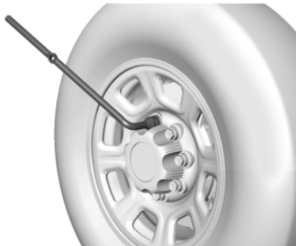
2. Si le véhicule est muni d'un capuchon de roue central et de capuchons d'écrous de roue, les capuchons d'écrous de roue sont conçus pour rester avec le capuchon de roue central après avoir été desserrés. Retirer l'ensemble du capuchon de roue central.
