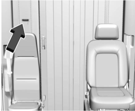
Pour ouvrir la porte coulissante (cloison), déverrouiller à l'aide du pavé tactile, puis tirer la poignée et faire glisser la porte sur le côté jusqu'au loquet.
