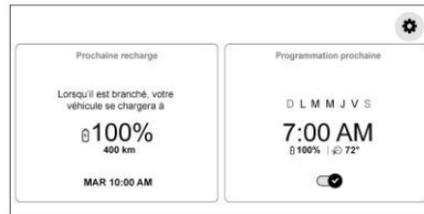
Pour lancer l'application de charge à partir de l'écran d'accueil de l'infodivertissement, toucher l'icône de charge. Trois sélections sont possibles : Charge suivante, Programme et Paramètres. Lorsque la charge est lancée, il existe deux options avec l'information suivante et le programme de charge à venir. Il est possible d'accéder aux paramètres à partir de l'engrenage dans le coin supérieur droit.
