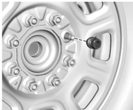
8. Enlever tous les écrous de la roue et retirer la roue à pneu plat.
