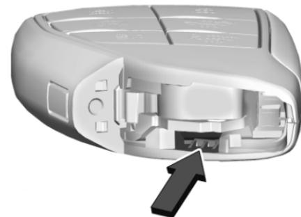
2. Utiliser la lame de la clé mécanique dans la fente pour séparer et retirer le couvercle arrière.
