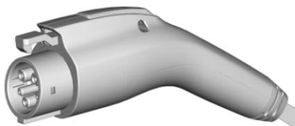
Fiche du câble de charge en courant alternatif du véhicule
